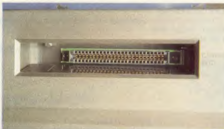
Vista frontal de la conexión de cartuchos ROM MSX.
